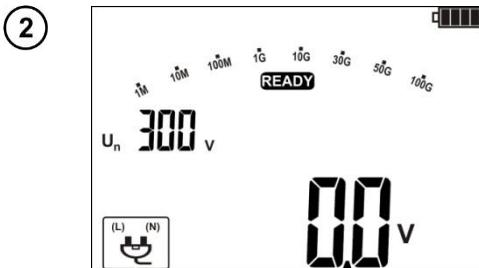
Después de poner el WS-04 / WS-11 al enchufe, en la pantalla aparece mnemotecnia que indica la detección del adaptador.
