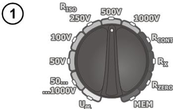
Poner el selector giratorio de función en una de las posiciones  $R_{ISO}$ , seleccionado al mismo tiempo la tensión de medición (en la posición de 50...1000V seleccionada para este rango cada 10V). El medidor está en modo de medición de tensión.
